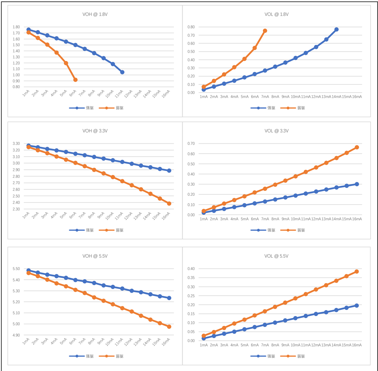
图 7-2 输出端口 VOH/VOL 实测曲线
